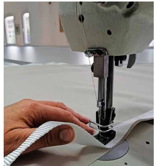
Handarbeit: Die Ränder des Segelstoffs werden mit einem stabilen Gurtband verstärkt und in Form gebracht.
