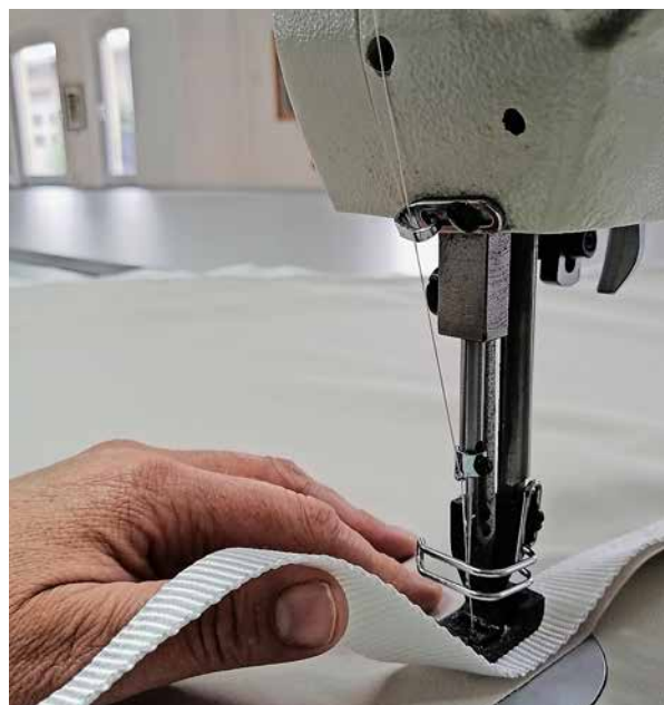
Handarbeit: Die Ränder des Segelstoffs werden mit einem stabilen Gurtband verstärkt und in Form gebracht.
